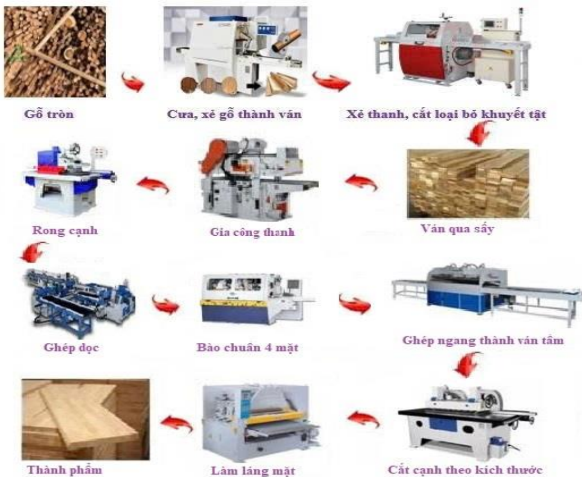
Hình 1.1. Các nguyên liệu, máy móc trong quy trình công nghệ sản xuất gỗ ghép thanh
